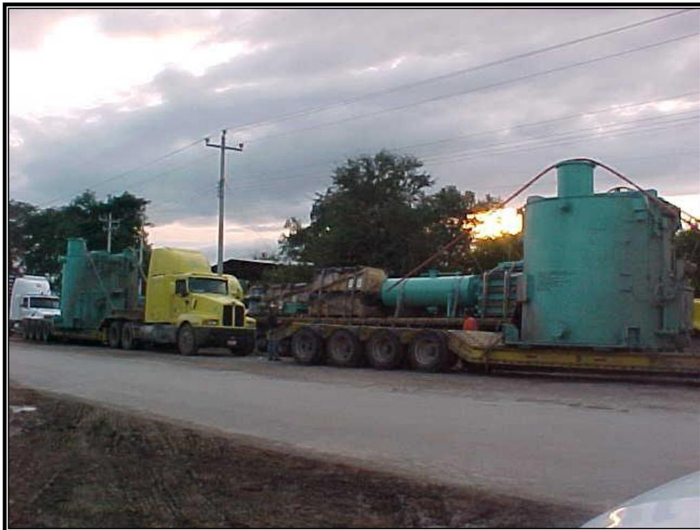
FIGURA 1.26 Proceso de Traslado del Transformador.
