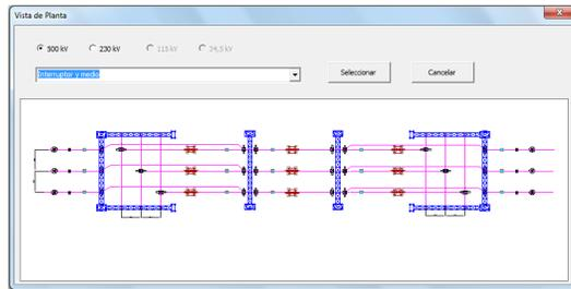
Fig. 5: Vista de planta - Interruptor y medio 500 kV
