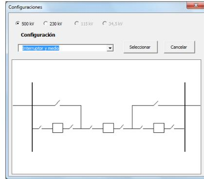
Fig. 3: Configuración Interruptor y medio - patio 1 500kV.
