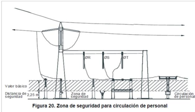
Figura 20. Zona de seguridad para circulación de personal
