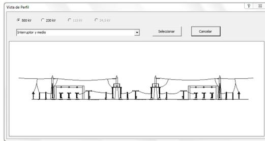
Fig. 10: Perfil Interruptor y medio 500 kV - ejemplo.
