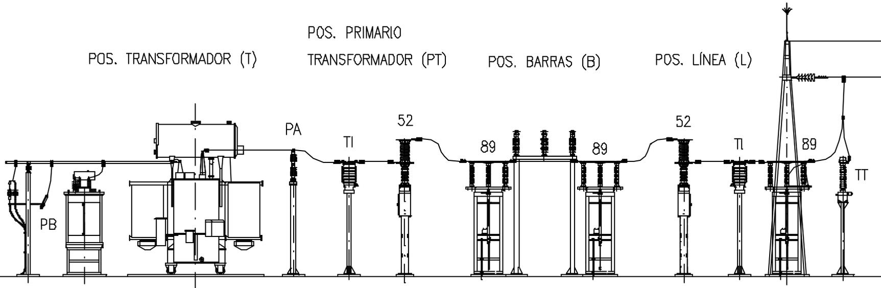
Ejemplo de S/E 66/15 kV de intemperie. Alzado de una posición de línea, barras y transformador
