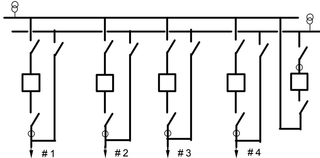
El interruptor de transferencia puede sustituir a cualquier otro interruptor
