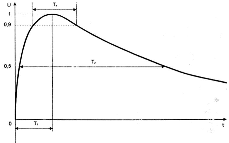
Onda de sobretensión tipo maniobra 250/2500  $\mu\text{s}$  normalizada según UNE 21308.
