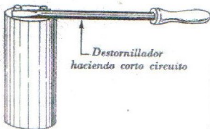
Fig. 2.80. — Prueba de un condensador. 2. a operación: desconéctese el condensador de la red y cortocircuitense sus bornes con un destornillador. Debe observarse una chispa.
