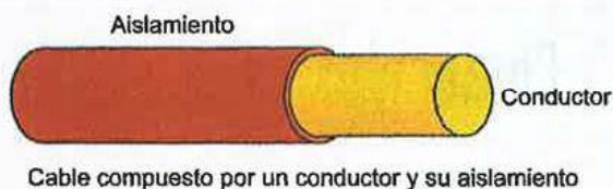
Figura 2.2. Concepto de cable y conductor.
