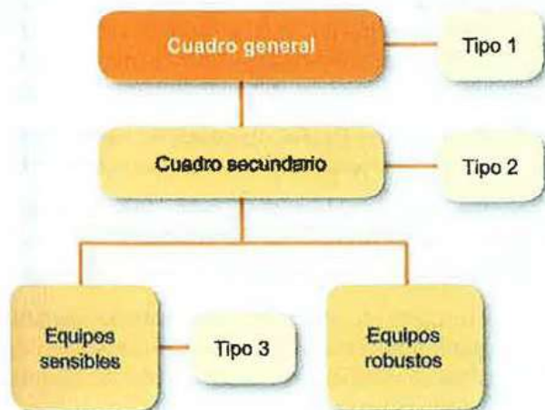
Figura 2.75. Ejemplo de una instalación con tres tipos de descargadores de sobretensiones.
