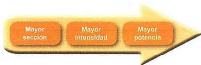
Figura 2.10. Relación entre la sección de un conductor y la intensidad y potencia del circuito.
