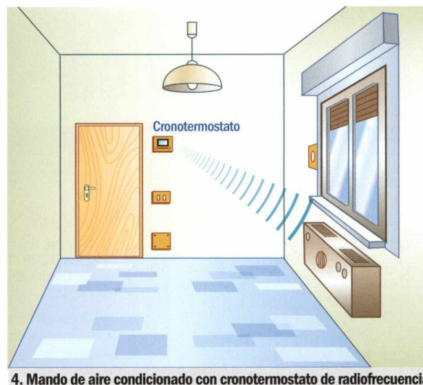
4. Mando de aire acondicionado con cronotermostato de radiofrecuencia
