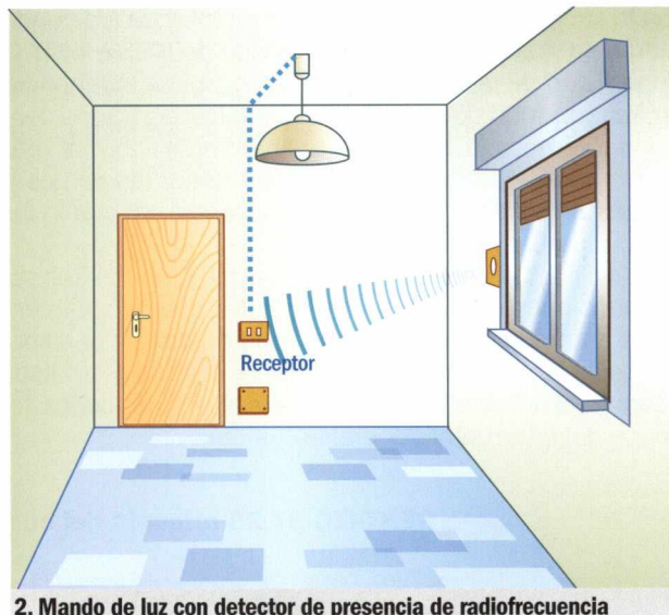
2. Mando de luz con detector de presencia de radiofrecuencia
