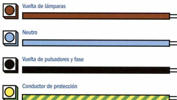
3. Tipos y características de conductores a emplear (sección 1,5 mm 2 )
