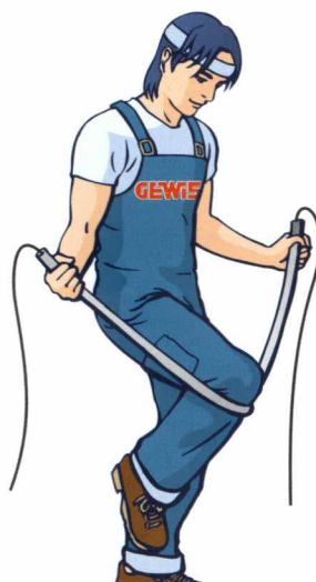
4. Curvar los tubos usando muelle espiral que permite realizar curvaturas hasta 90°
