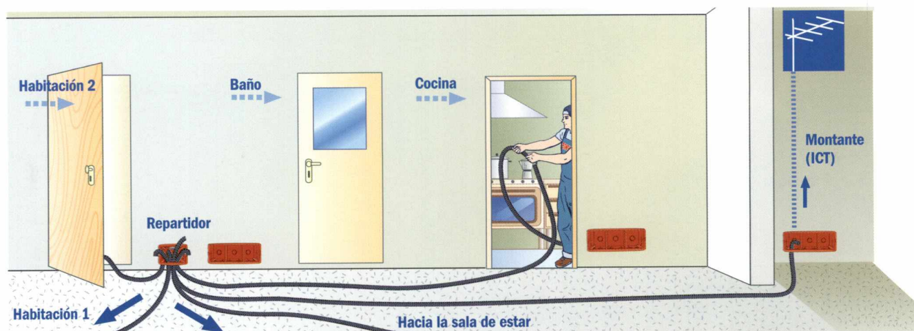
5. Ejemplo de posicionamiento en el pasillo de los tubos que conectan la caja de derivación con las cajas instaladas en cada estancia
