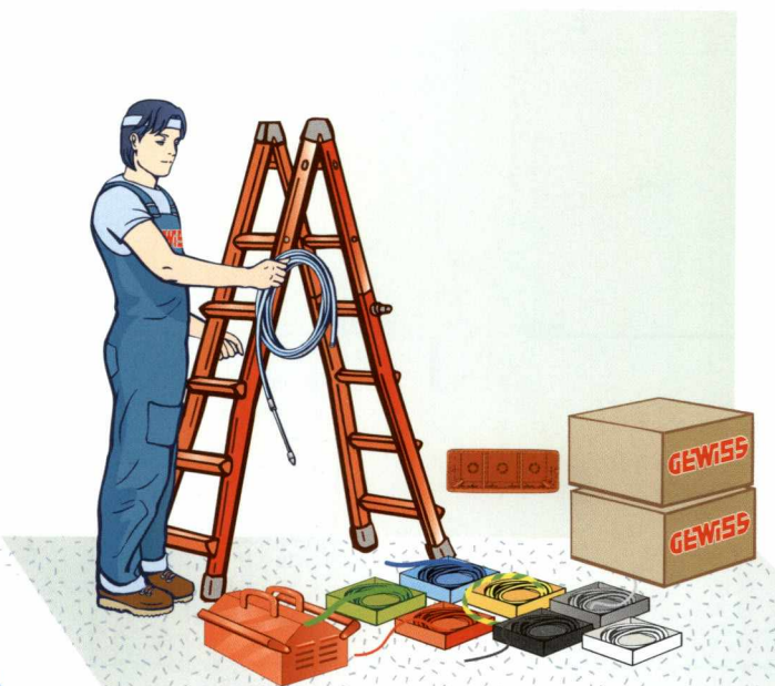
2. Acopiar en obra los cables, bornes, mecanismos y placas para poder acabar el trabajo en una única actuación
