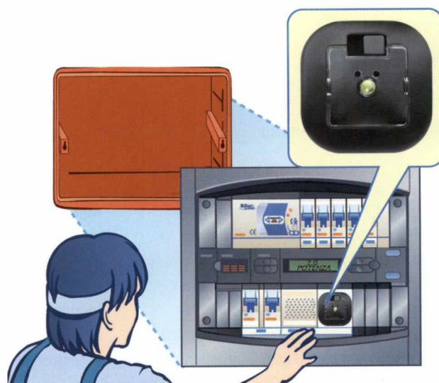
4. La lámpara de emergencia es recomendable ubicarla en el cuadro para facilitar el rearme de los interruptores automáticos después de un disparo
