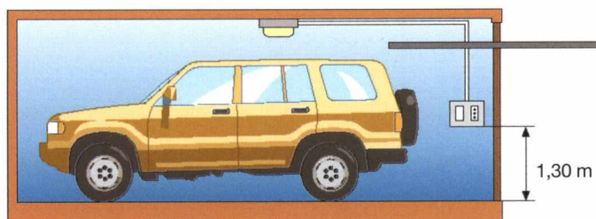
Instalación de los conductores y de las bases a altura no inferior que 1,30 m para evitar el riesgo de impacto con el auto
