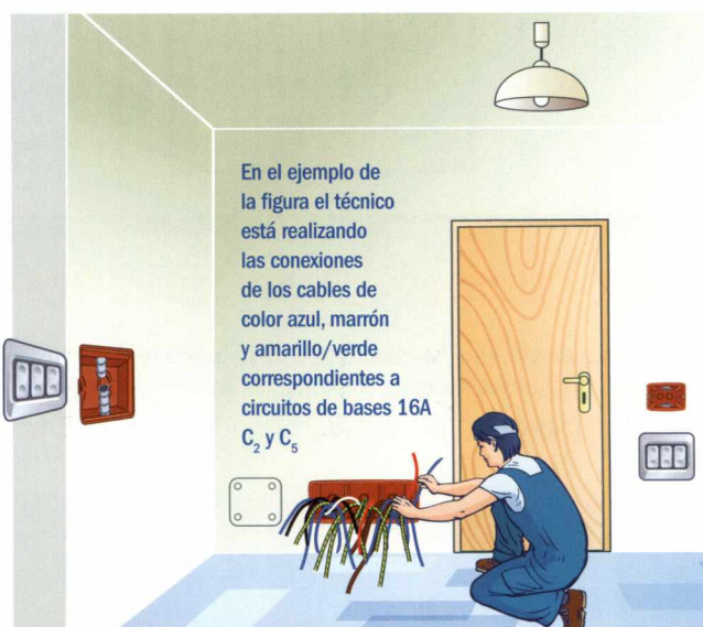
4. Operación inicial para realizar la conexión de la caja de derivación
