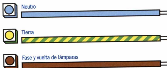
3. Tipos y características de conductores a emplear (sección: 1,5 mm 2 )
