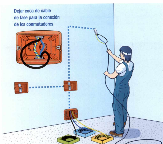
4. Tendido de conductores con la guía entre cajas de mecanismos, caja de conexiones y punto de luz
