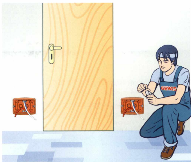
3. Conexión de las bases de enchufe
