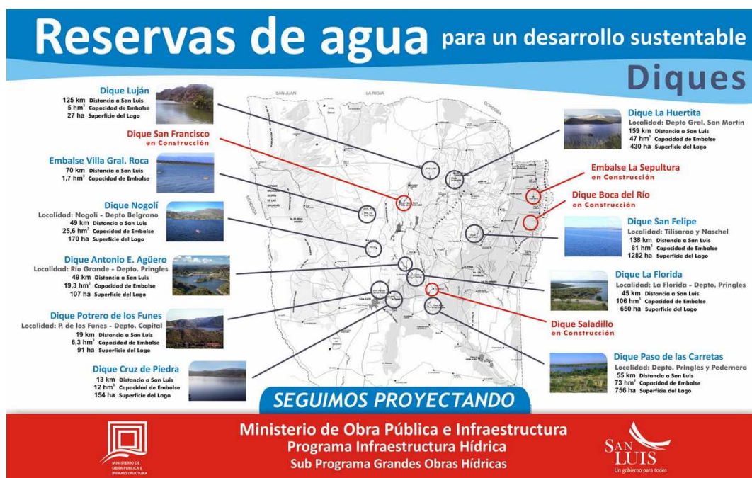
Figure 7: Diques construidos y planificados
