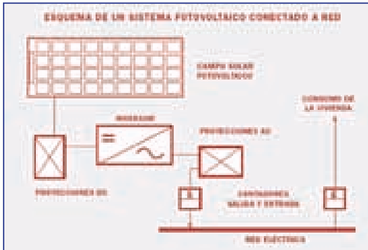
Figura 4. Instalación conectada a la red.
