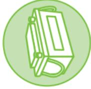
**CONTROLADOR DE CARGA.** Impide que las baterías reciban energía cuando alcanzan su carga máxima y alargan su vida
