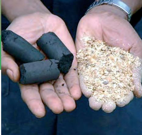
Las briquetas son cilindros (de 50 a 130 mm de diámetro y de 5 a 30 mm de longitud). Tienen una densidad elevada (entre 1.000 y 1.300 kg/m<sup>3</sup>) y se fabrican por medio de prensas, en las que el
