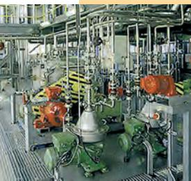
*Obtención de biodiesel en una planta compacta pequeña, de una producción de 500 l/h (tecnología BDT, Austria). El consumo eléctrico de esta planta se puede cifrar en 30 Wh por cada litro de biodiesel producido, lo que traducido a energía primaria sería de 103 kcal (con un rendimiento eléctrico del 25 %).*
