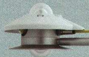
↑ Figura 1.49. Albedómetro. (Kipp&Zonen).
