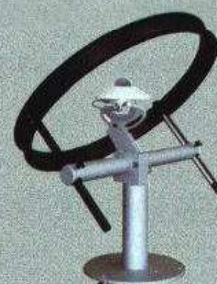
↑ Figura 1.48. Piranómetro con banda de sombra para medir la radiación difusa. (Kipp&Zonen).
