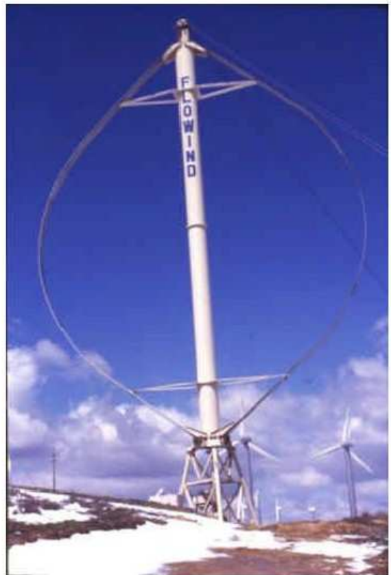
Figura 14. Turbina de eje vertical
