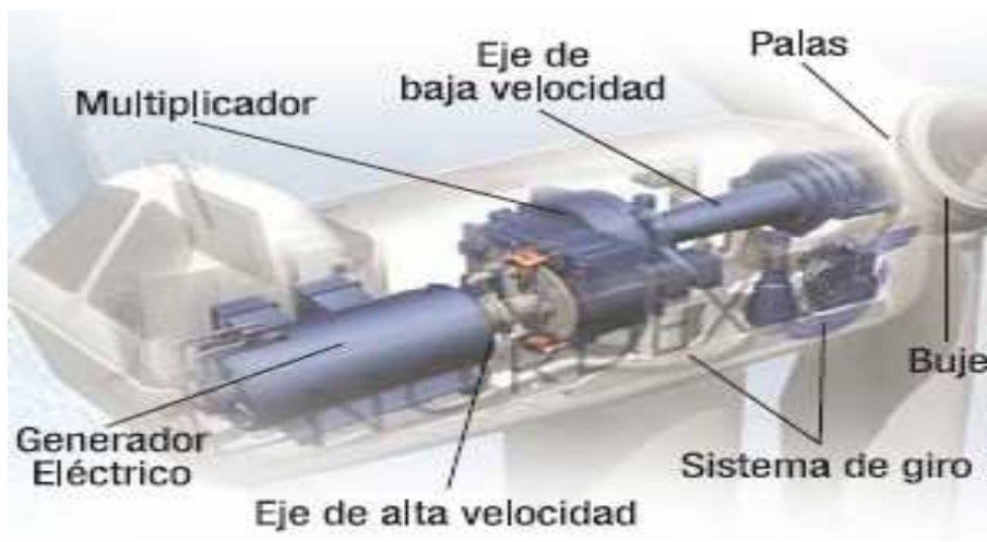
Figura 52. Aerogenerador Nordex 60/250 1300KW.
