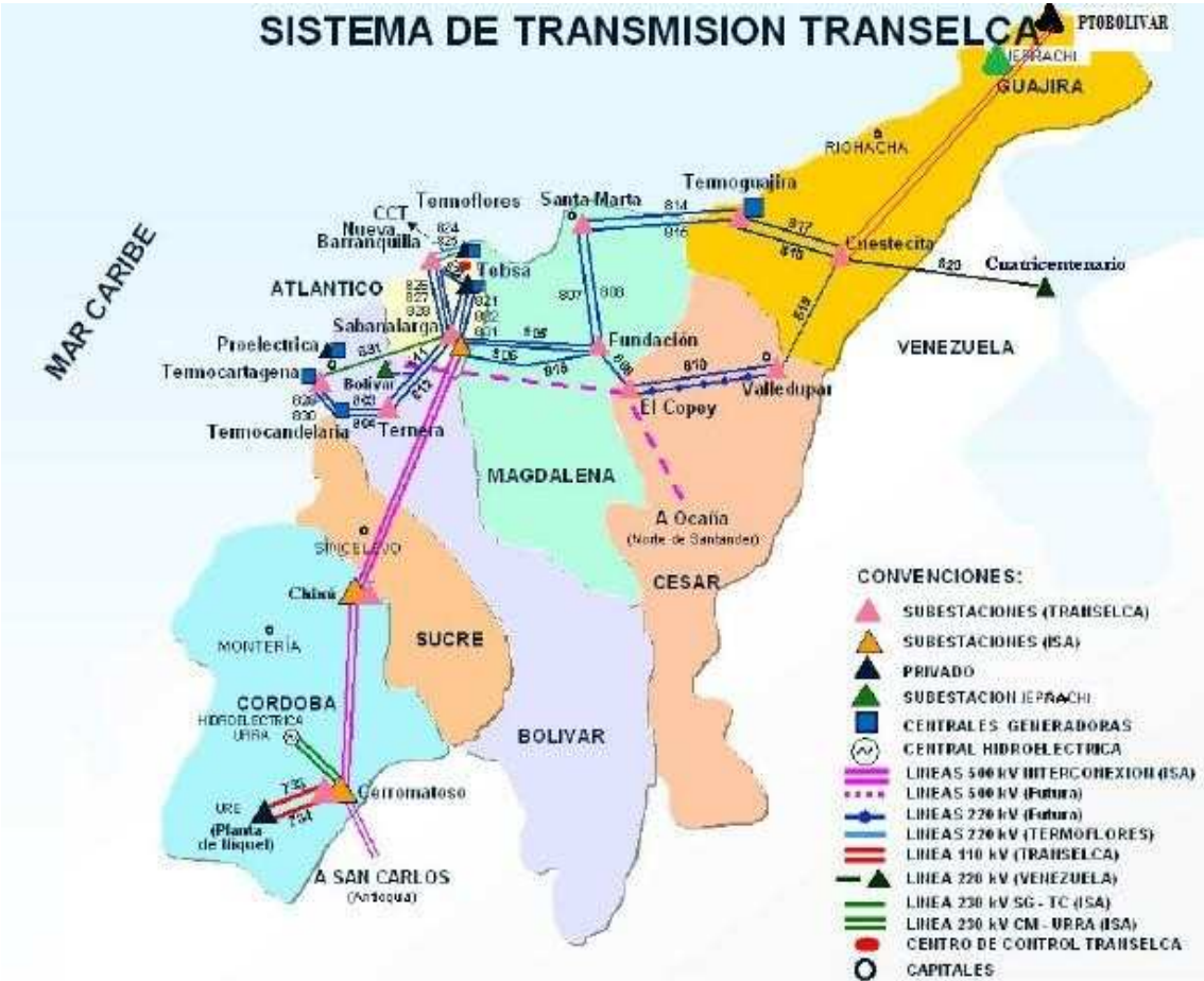
Figura 56. Sistema de Transmisión del Norte de Colombia, Jepirachi se encuentra en el extremo Norte a 8 km de la Subestación Puerto Bolivar salida al mar de la Explotación Carbonífera Cerrejón.
