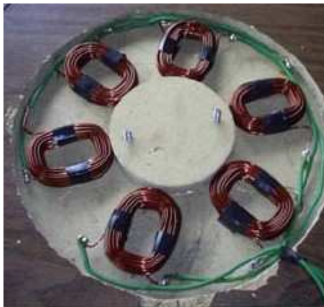
Figura 78. Bobinas eléctricas del generador de imanes permanentes.
