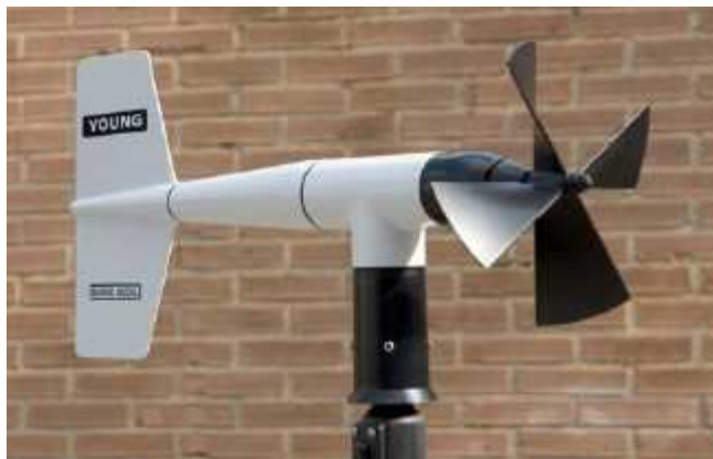
Figura 44. Veleta y Sensor marca Young, para determinar la dirección y velocidad del viento.
