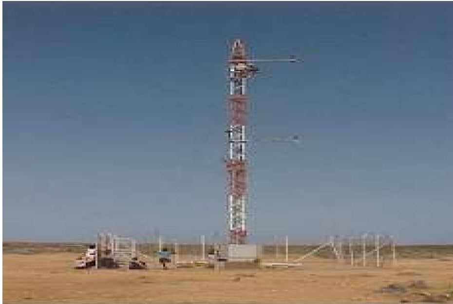
Figura 42. Estación de medición meteorológica y monitoreo vía satélite con sistema GOES. [23]
