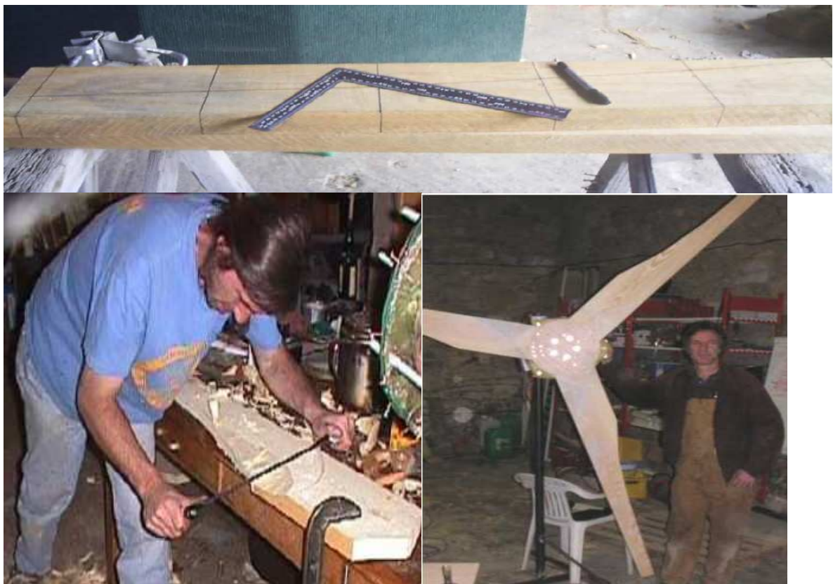
Figura 73. Detalles de la fabricación de los alabes de madera, dándole los ángulos \beta a las secciones y ensamblándolas al rotor.
