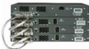
Los switches apilables, conectados por un cable especial, operan con eficacia como un gran switch.
