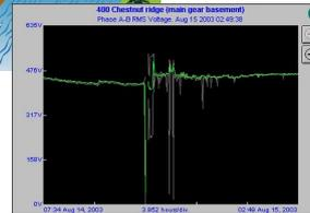
*Ejemplo: Cuando los sistemas de reconexión automática operan de forma repetida, por ejemplo, debido a la caída de ramas de árboles en las líneas de distribución, causan fluctuaciones de tensión tal como se muestra en el gráfico anterior*
