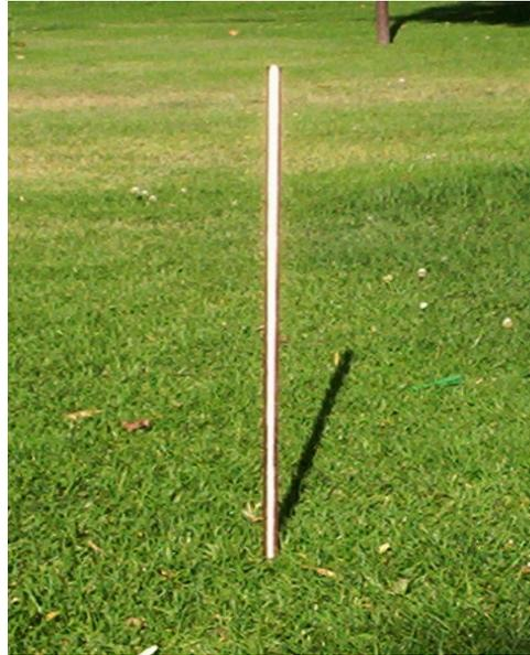
**FIGURA 34 VARILLA DE ACERO RECUBIERTA DE COBRE (VARILLA COPPERWELD).**
