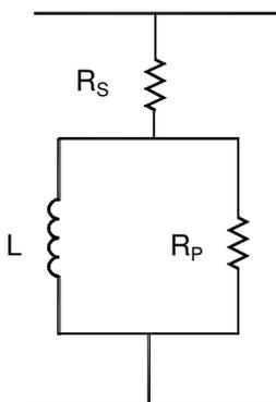
Figura 12. Modelo del transformador para análisis de armónicos
