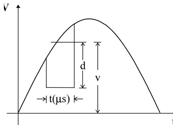
**Figura 10. Hendidura en una onda de tensión**
