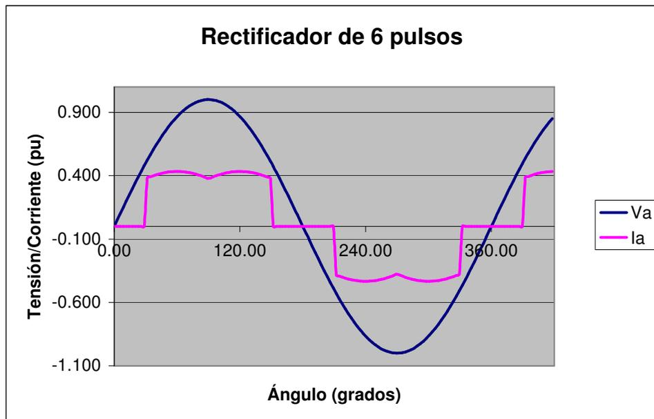
Figura 4. Corriente de un rectificador de 6 pulsos
