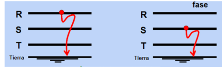
Fallas monofásicas simultáneas - Cross country fault
